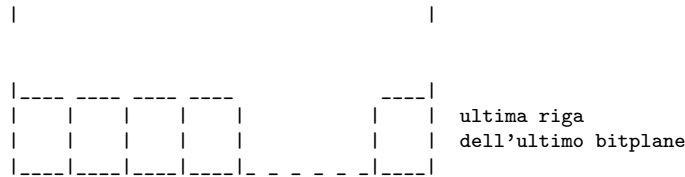
Fig. 12 Rappresentazione in memoria di un'immagine a più bitplane (ogni quadrato è una word)
